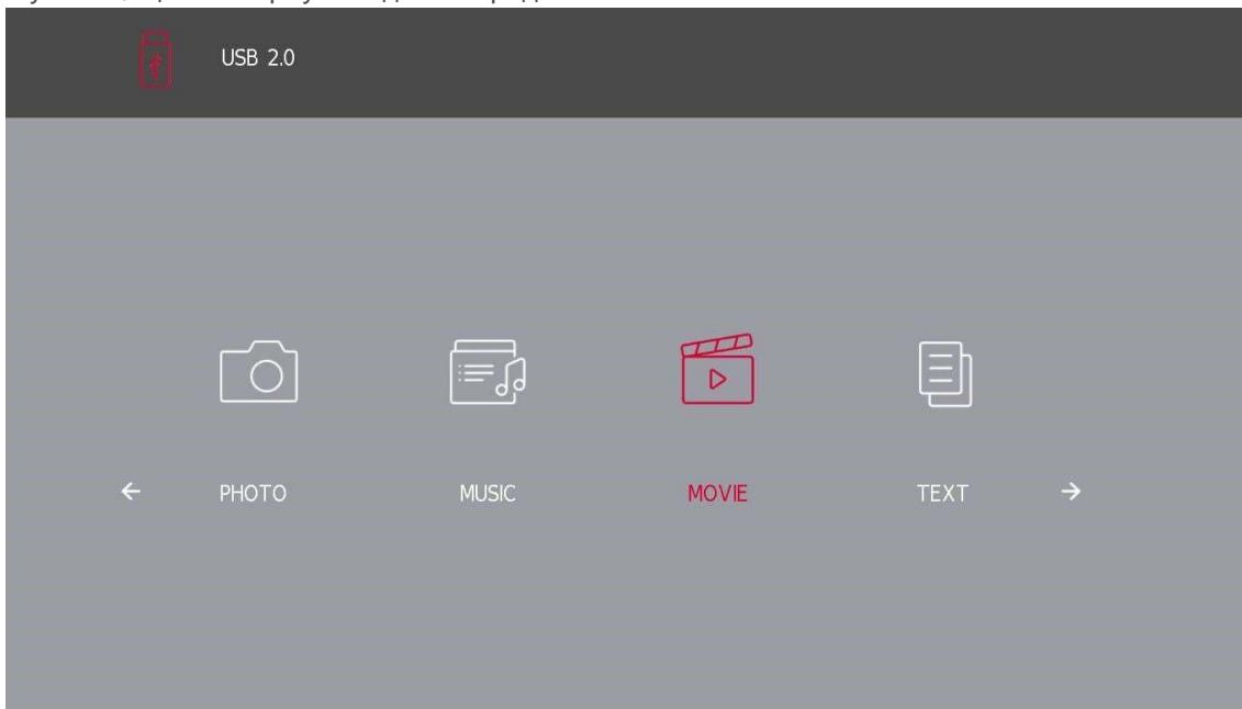
За допомогою кнопок **◀/▶**виберіть диск, який ви хочете переглянути, а потім натисніть кнопку Ok для продовження.
