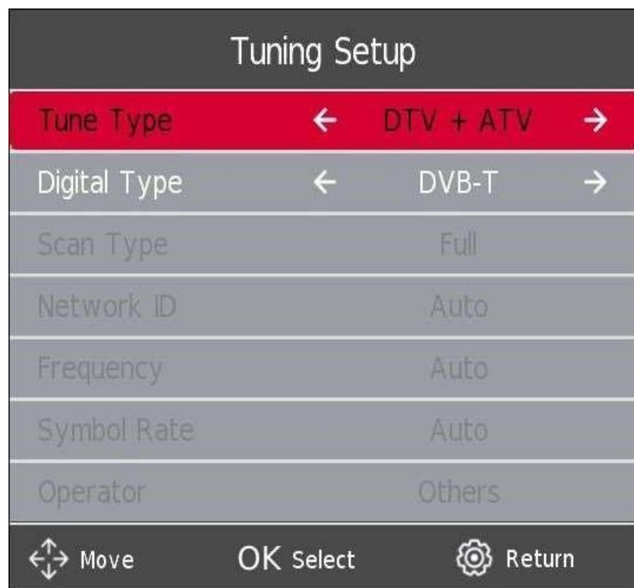
При виборі ATV+DTV буде виконано два сканування окремо. Щоб зупинити перше сканування, необхідно спочатку натиснути кнопку **НАЛАШТУВАННЯ/МЕНЮ**, а потім підтвердити свій вибір кнопкою **ВЛІВО**. Після цього автоматично почнеться друге сканування. Якщо ви хочете перервати друге сканування, натисніть кнопку **НАЛАШТУВАННЯ/МЕНЮ** ще раз і підтвердіть вибір лівою кнопкою.
